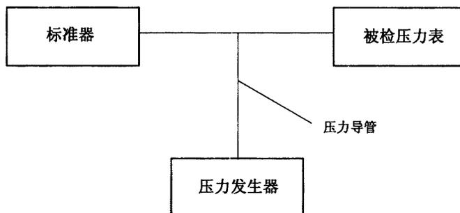
图 1 压力表示值检定连接示意图
